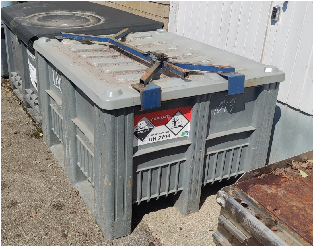
Kuva 1. Asianmukaisesti järjestetty akkujen säilytys ulkotiloissa.
