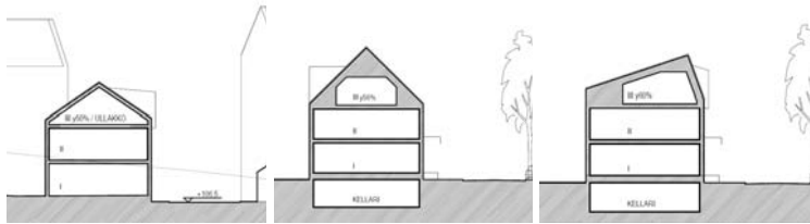
Kuva 20. Kaavamerkintä II, III y50-70 ja III y50-70. Erilaisia kaavamerkinnän toteuttavia vaihtoehtoja. Lähtökohtaisesti kaava määrää kattokulmaksi 1:1,5 tai enemmän. Alleviivattu roomalainen numero edellyttää rakentamisen kolmeen tasoon. Lisämerkintä y/50-70 edellyttää kattokerrokseen sijoitettavaksi kerrosalaan laskettavia tiloja luvun osoittaman prosenttimäärän alemman kerroksen alasta. Olennainen vaatimus on, että kadun puolelle julkisivu on korkeintaan kaksi täyttä kerrosta ja ylin, vajaa kattokerros, on merkinnästä riippuen joko tyypillinen harjakatto (vasen, keskellä) tai epäsymmetrinen jyrkkälapeinen harjakatto (oikealla). Edellisten lisäksi hyväksytään mahdolliset kattoterassit. Kellari ja ullakko ovat aina, maaston muodot huomioiden, mahdollista rakentaa.
