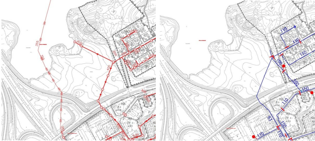
Kuva 9, vasemmalla jätevesiverkosto 2014 ja oikealla vesihuoltoverkosto 2014.
